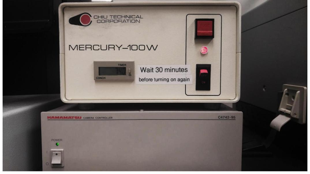
TURN ON THE MERCURY BULB AND CAMERA CONTROLLER IN ANY ORDER. (NO SEQUENCE REQUIRED)
